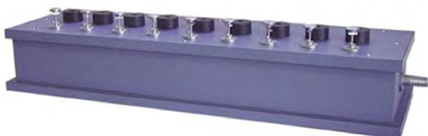
**APPARECCHIATURA PER LA MISURA DELLA VELOCITÀ DEL SUONO NELL'ARIA**
